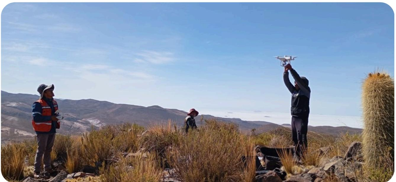
**LEVANTAMIENTO FOTOGRAMÉTRICO CON EQUIPO DRON PHANTOM 4 RTK**
