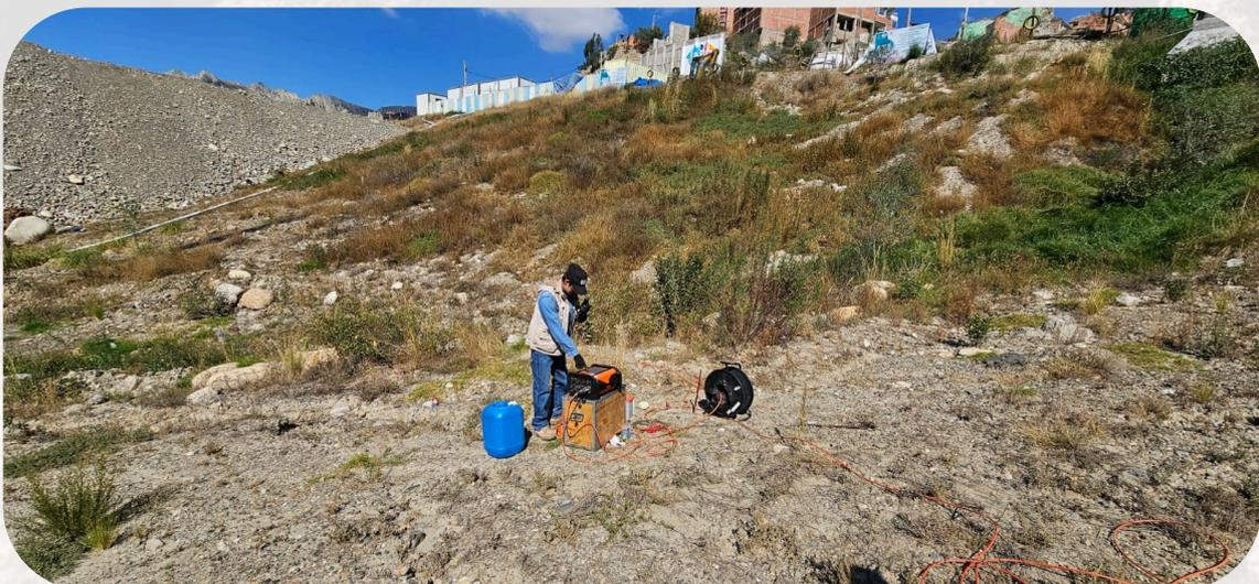
ADQUISICIÓN DE DATOS GEOFÍSICOS CON EL EQUIPO ABEM TERRAMATER LS2
