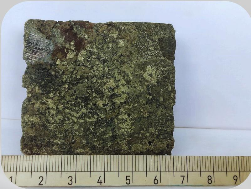
Fig. 9. Muestra MNS-36. Veta con esfalerita, marcasita, arsenopirita, cuarzo y arcillas blanquecinas.
