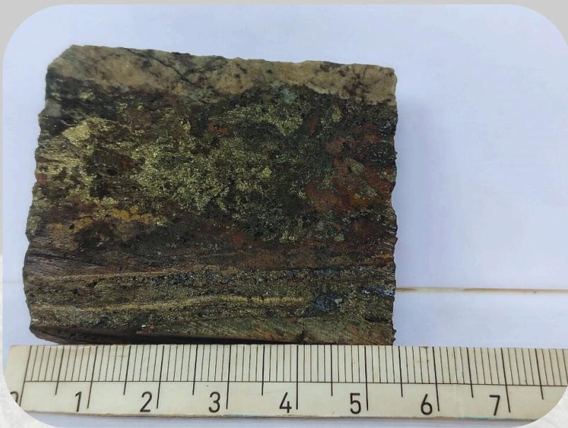
Fig. 7. Muestra MNS-33. Veta con bandas de marcasita, esfalerita, galena, casiterita y cuarzo.
