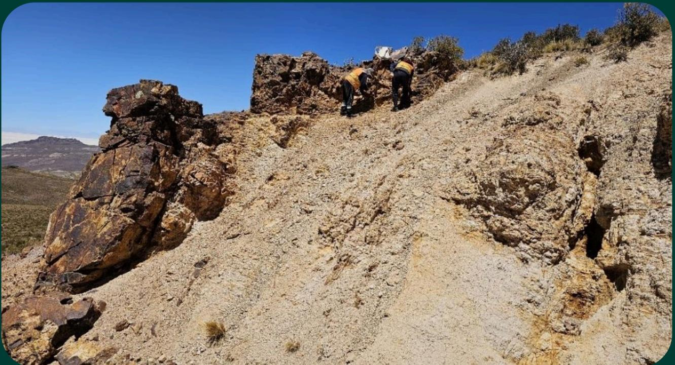
(Figura 3) - Proceso de mapeo y muestreo de una estructura vetiforme oxidada
