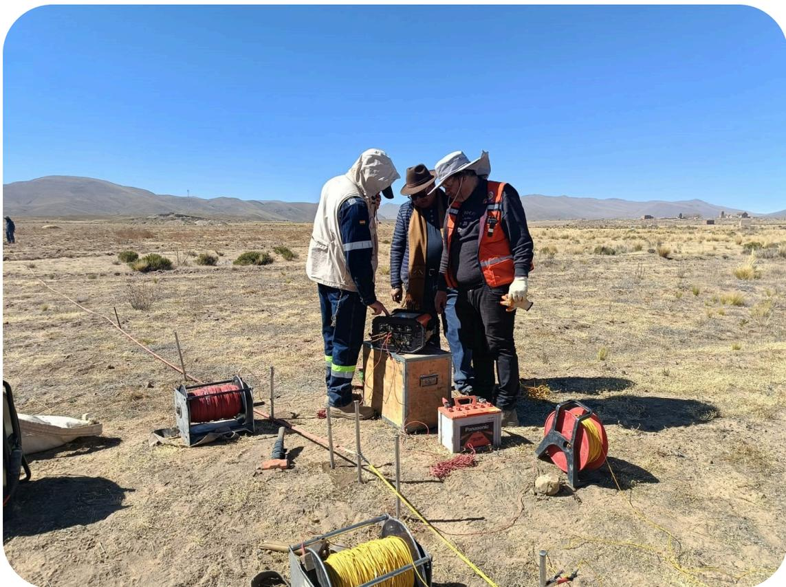
**MÉTODO DE SONDEO ELÉCTRICO VERTICAL SEV**
