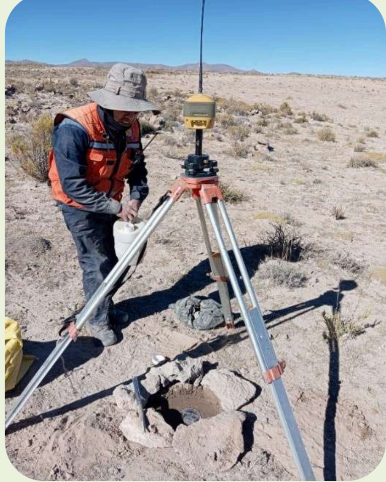
Equipo GPS Geodésico
