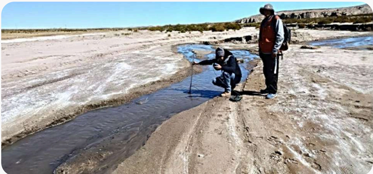
Medición de Caudal en el río Kulla
