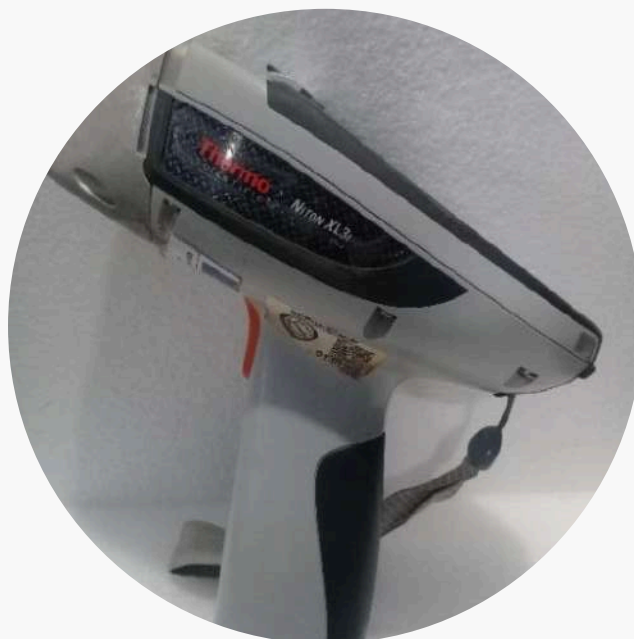
Pistola Thermo Scientific Niton XL3t Ultra, para análisis de Fluorescencia de Rayos X en muestras de rocas y minerales
