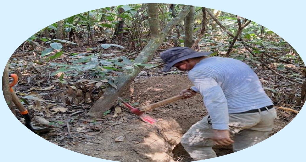
Depósitos recientes próximos al río Beni donde se realizó muestreo de sedimentos con un pozo de 0,90 m de profundidad.
