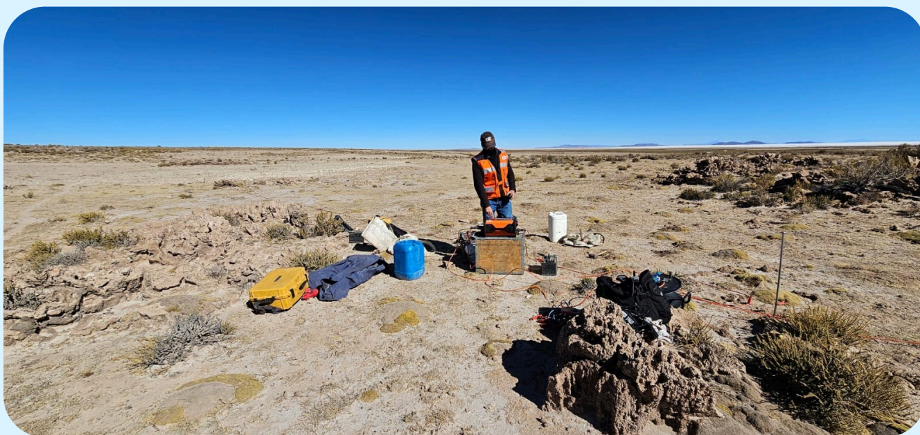
Equipo de Tomografía Eléctrica Resistiva 2D
