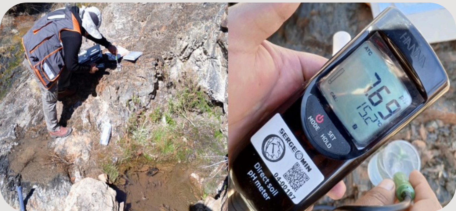
Determinación de los parámetros físico-químicos de aguas in situ, con la ayuda del equipo portátil (HI 99121 KIT)
